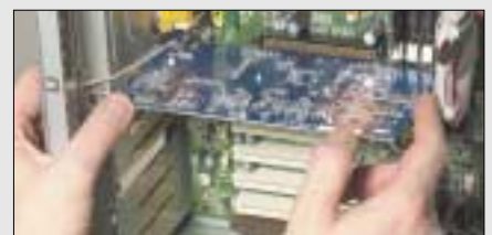
Stecken Sie die neue Karte vorsichtig in den AGP-Steckplatz.
